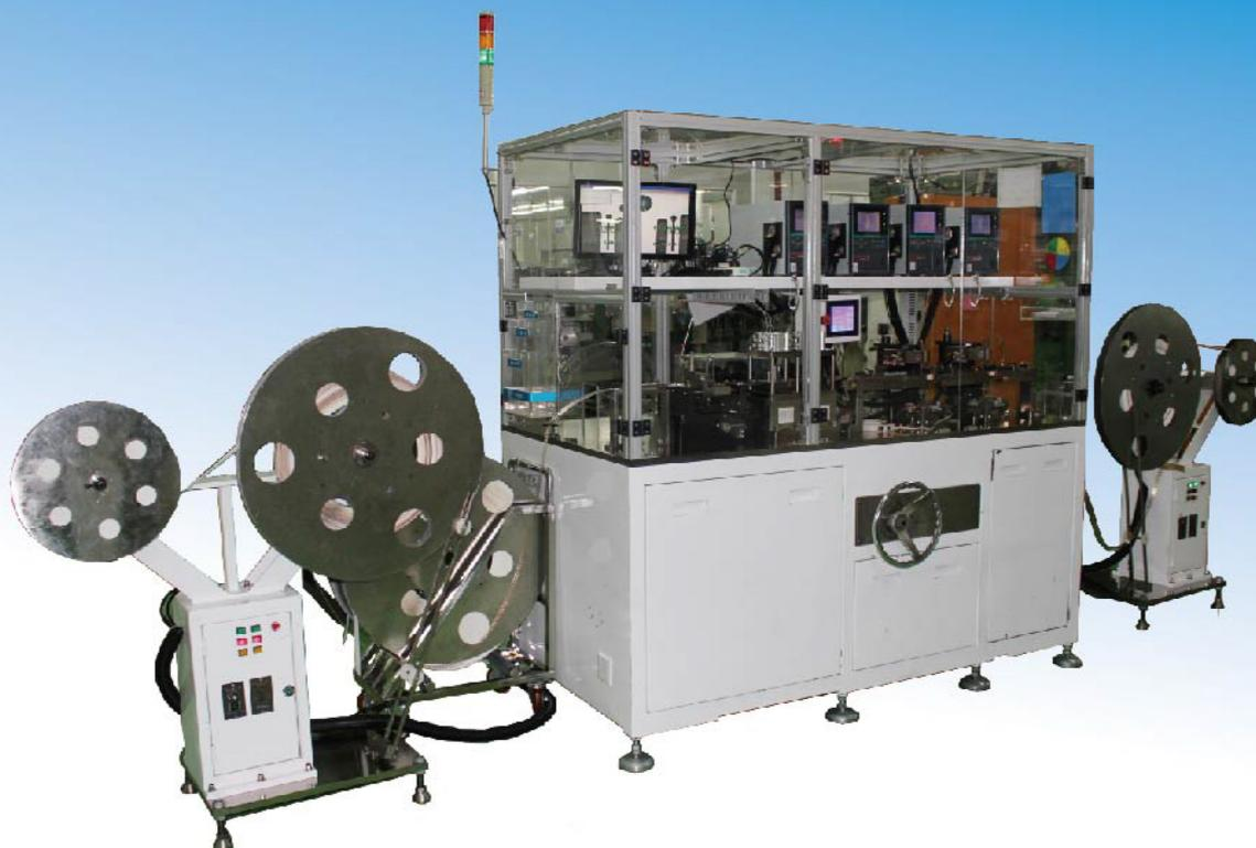
动静簧带料触点点焊机是在带料上焊接触点的全自动化设备，包括带料自动送料、自动走动、自动定位，焊丝自动送入、自动切断，焊丝与带料在确定的位置上自动焊接，对焊接触点自动检测，对不良品自动打标记（整形、切除），良品吹灰，自动收料等全过程均自动化控制。点焊头个数可根据生产需求而定，焊接速度最高可达100次/min从而极大的提高了设备效率。整机采用机械传动方式，保证了动静簧带料触点的焊接精度的稳定性和可靠性。
