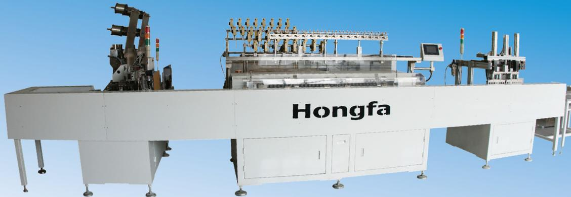
HFRA3240全自动绕线机(包括绕线前的自动插端子机)主要由自动插端子机和全自动绕线机二大部分组成,可集自动插端子、自动排料、自动上下料、自动绕线等功能于一体的全自动绕线机。
