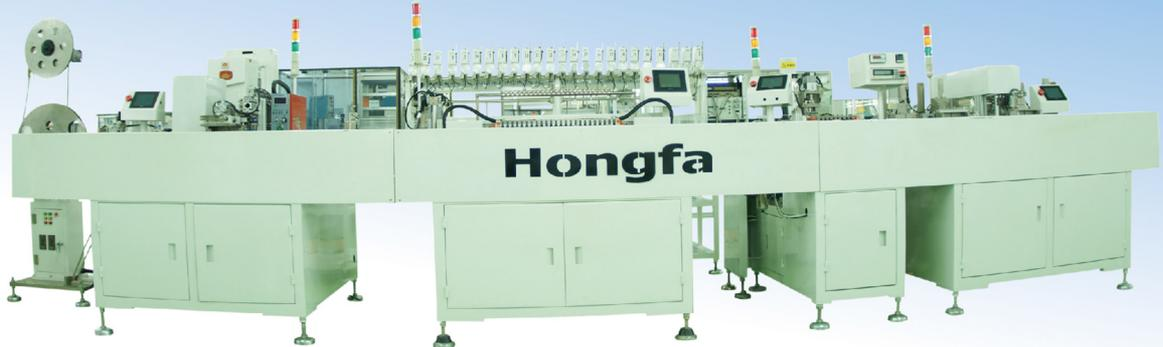
HFD3全自动切料绕线沾锡排版机主要由自动切断上料机，自动绕线机，自动沾锡机，自动排版机四部分组成，本机为自动绕线部分。绕线机系四轴联动，绕线圈数精确可设定，绕线速度自动可调，主轴标准转速13,000rpm,最高转速可达20,000rpm。
